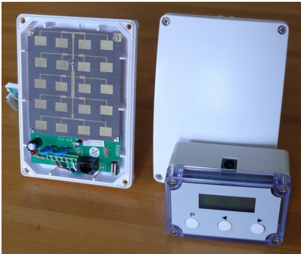
Esempio di Sensore "White Beam" e Calibratore "Calibration White"
